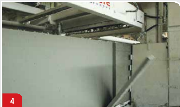
Переработка боковых обрезков (100%) - во время продольной резки
