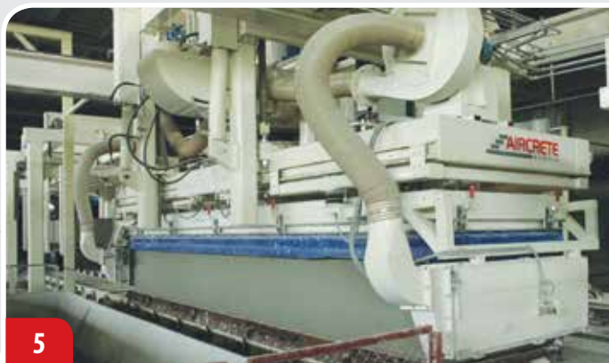
Снятие верхнего подрезного слоя и торцевых обрезков
