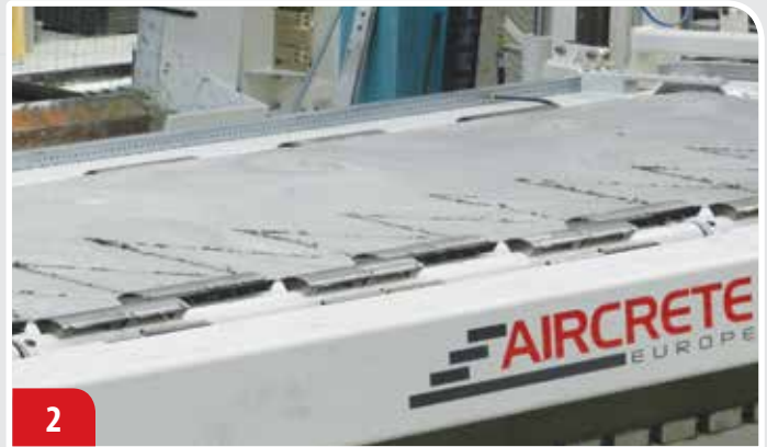
2 Cadre incliné pendant la coupe transversale
