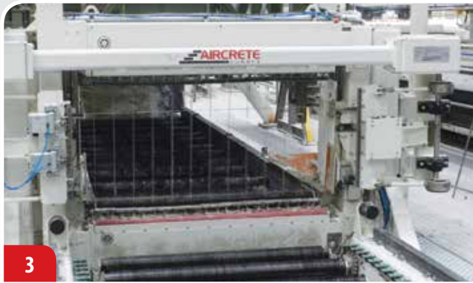
3 Cadre de Découpe Grande Vitesse- découpe horizontale et verticale
